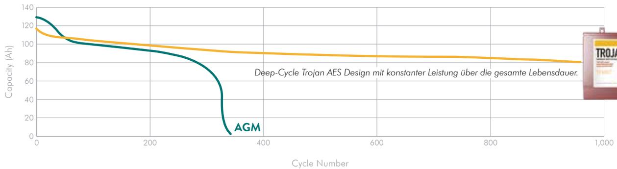
**Trojan AES behält seine hohe Kapazität selbst bei extremen Entladungen (bis zu 100 % DoD) mit gleichbleibender Leistung über die gesamte Lebensdauer im Vergleich zu Standard-AGM.**
